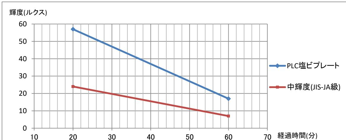
※1 「照度」、「紫外線強度」及び「輝度」は、照度計(JIS C 1609-1の適合品等)、紫外線強度計(おおむね360nm～480nmの範囲を測定できるもの)、輝度計(色彩輝度計等)を用いて測定した結果を記載。
